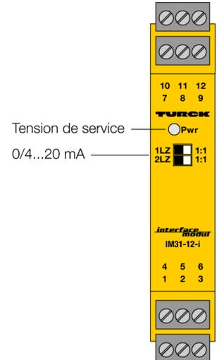
Les signaux de tension ou de courant actifs normalisés sont séparés galvaniquement par le séparateur de signaux analogiques mono-canal IM31-12-I et ensuite transmis. Le signal est dupliqué et est disponible alors aux deux sorties.
