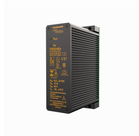
Das Netzteil PSD24Ex dient der Versorgung des excom®-Systems bis zum Vollausbau. Das Netzteil ist in einer kombinierten Schutzart Ex m, Ex e sowie Ex i ausgeführt und kann daher in Zone 1 eingesetzt werden. Es ist vollvergossen in einem Aluminium-Schutzgehäuse eingebaut.
