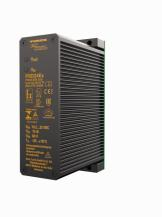
L'appareil d'alimentation PSD24Ex sert de l'alimentation du système excom® jusqu'à l'installation complète. La platine est conçue dans un mode de protection combiné Ex m, Ex e et Ex i et permet donc d'être utilisé dans la zone 1. Il est entièrement surmoulé et logé dans un boîtier de protection en aluminium.
