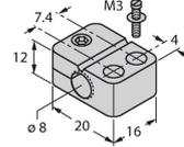
Befestigungsschelle für Gewinderohrsensoren, mit Festanschlag; Werkstoff: PA6
