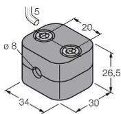
Befestigungsschelle für Glatt- und Gewinderohrsensoren; Werkstoff: Polypropylen
