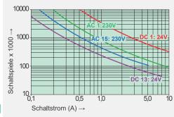
Max. Schaltvermögen (DIN EN 60947-5-1, Tab. C2):
