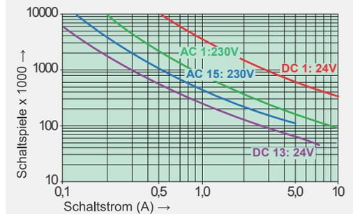
Max. Schaltvermögen (DIN EN 60947-5-1, Tab. C2)
