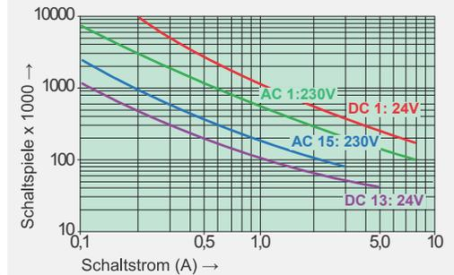
Max. Schaltvermögen (DIN EN 60947-5-1, Tab. C2)
