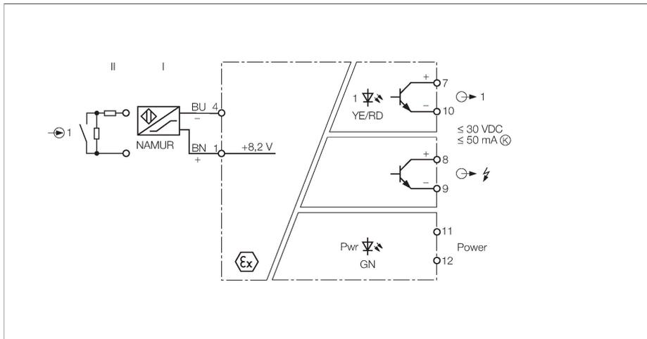
Der 1-kanalige Trennschaltverstärker vom Typ IM1-121EX-T ist mit einem eigensicheren Eingangskreis ausgestattet.
