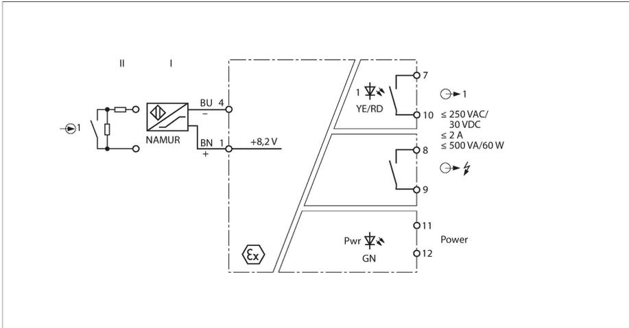
L'amplificateur séparateur monocanal du type IM1-121EX-R est équipé d'un circuit d'entrée à sécurité intrinsèque.
