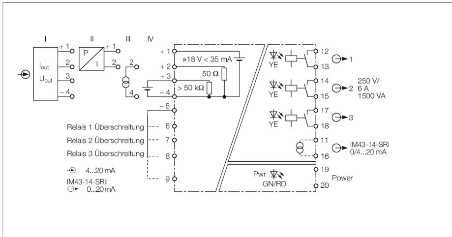
Der 1-kanalige Grenzwertsignalgeber IM43-13-SR überwacht alternativ Messströme von 0/4...20 mA oder Messspannungen von 0/2...10 V auf Überschreitung und Unterschreitung von Grenzwerten.
