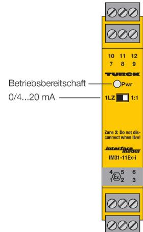
Über den 1-kanaligen Analogsignaltrenner IM31-11EX-I werden normierte, aktive Spannungs- oder Stromsignale galvanisch getrennt aus dem Ex-Bereich in den Nicht-Ex-Bereich übertragen.
