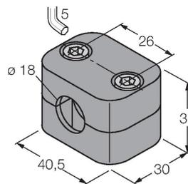
Befestigungsschelle für Glatt- und Gewinderohrsensoren; Werkstoff: Polypropylen
