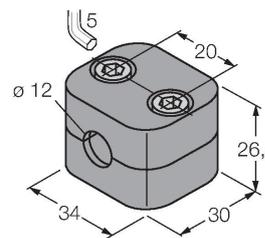
Befestigungsschelle für Glatt- und Gewinderohrsensoren; Werkstoff: Polypropylen
