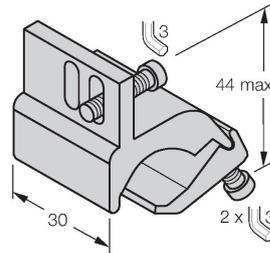
Pièce de serrage pour le montage de détecteurs de champs magnétiques sur vérins profilés ; diamètre du vérin : 50...100 mm ; matériau : Aluminium
