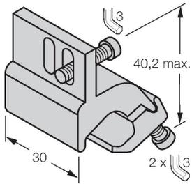
Pièce de serrage pour le montage de détecteurs de champs magnétiques sur vérins profilés ; diamètre du vérin : 32...50 mm ; matériau : Aluminium
