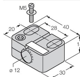
Befestigungsschelle für Gewinderohrsensoren, mit Festanschlag; Werkstoff: PA6
