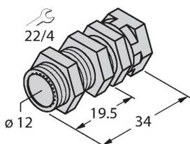
bride de fixation pour montage rapide avec butée fixe; matériau: Laiton chromé. Filetage externe M16 × 1. Conseil: La distance de commutation des capteurs de proximité peut être modifiée par l'utilisation de brides de fixation pour montage rapide
