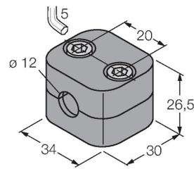
Bride de fixation pour détecteurs à tube fileté et lisse ; matériau : polypropylène
