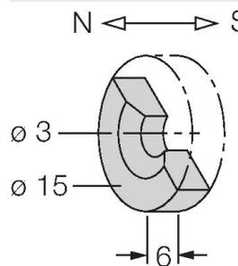
Aimant de commande, Ø 15 mm (Ø 3 mm), h: 6 mm ; distance de commutation atteignable de 36 mm pour les détecteurs de champs magnétiques BIM-(E)M12 ou 32 mm pour les détecteurs BIM-EG08 ; en cas d'utilisation avec des détecteurs de positionnement linéaire Q25L : distance recommandée entre le détecteur et l'aimant : 3...4 mm
