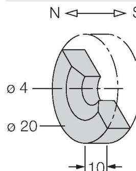
Aimant de commande; Ø 20 mm (Ø 4 mm), h: 10 mm ; distance de commutation atteignable de 59 mm pour les détecteurs de champs magnétiques BIM-(E)M12 ou 50 mm pour les détecteurs BIM-EG08 ; en cas d'utilisation avec des détecteurs de positionnement linéaire Q25L : distance recommandée entre le détecteur et l'aimant : 3...4 mm
