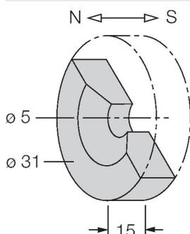
Aimant de commande, Ø 31 mm (Ø 5 mm), h: 15 mm ; distance de commutation atteignable de 90 mm pour les détecteurs de champs magnétiques BIM-(E)M12 ou 78 mm pour les détecteurs BIM-EG08 ; en cas d'utilisation avec des détecteurs de positionnement linéaire Q25L : distance recommandée entre le détecteur et l'aimant : 3...5 mm
