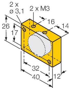
Aimant de commande ; rectangulaire et en plastique ; distance de commutation atteignable de 58 mm pour les détecteurs de champs magnétiques BIM-(E)M12 ou 49 mm pour les détecteurs BIM-EG08 ; en cas d'utilisation avec des détecteurs de positionnement linéaire Q25L : distance recommandée entre le détecteur et l'aimant : 3...5 mm
