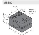
69479 Bride de fixation pour détecteurs à tube fileté ; matériau du bloc de montage : aluminium, anodisé
