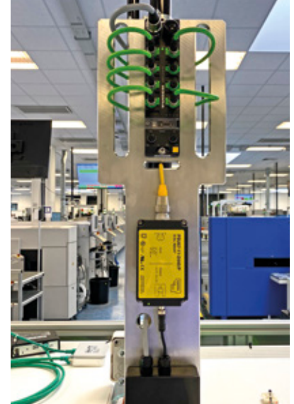
Robust und kompakt: Schaltschranklos verbinden das IP67-Netzgerät und der IP67-Switch die Sensoren mit dem MES
