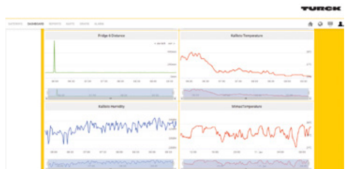
Predictive Maintenance: Die Betrachtung von Temperatur und Feuchte über lange Zeiträume erlaubt Rückschlüsse auf Verschleiß der Dichtungen
