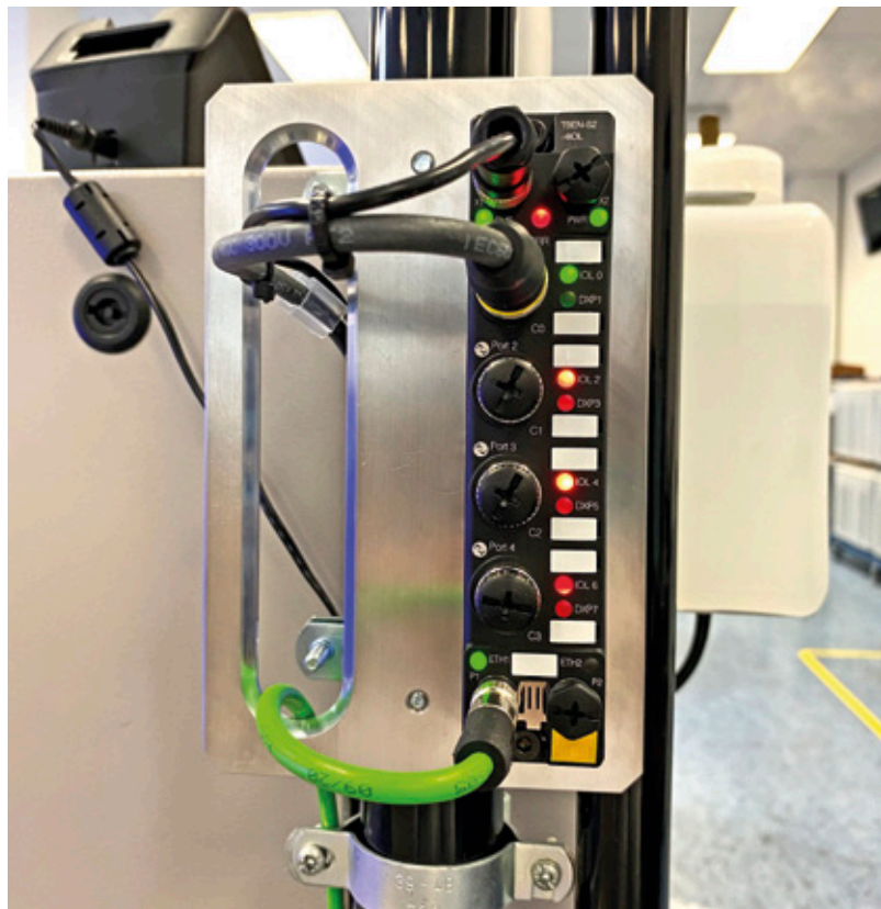
„Gehirn“ des Systems: Der Linux-basierte IM18-CCM schlägt per Ethernet die Brücke von der OT in die IT
