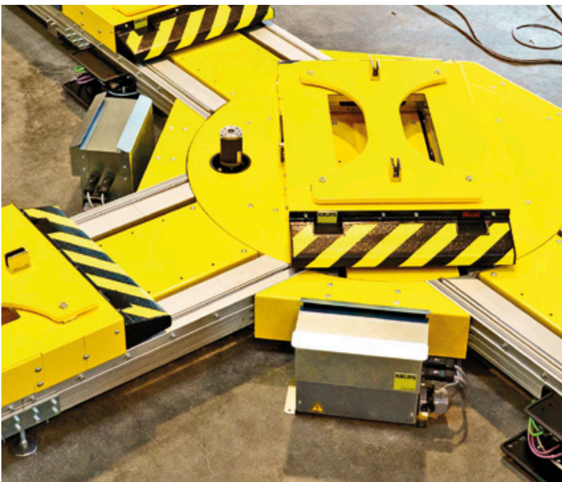
Das eCart-System kommuniziert an den Stoppfern und anderen Funktionsmodulen mit den Wagen über NFC
