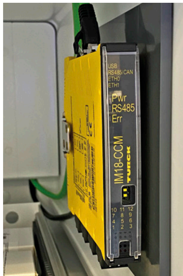
„Gehirn“ des Systems: Der Linux-basierte IM18-CCM schlägt per Ethernet die Brücke von der OT in die IT
