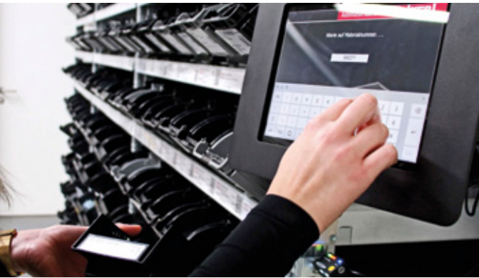
Die haus eigene KEB-Steuerung läuft auf einem am Regal angebrachten Windows-Tablet
