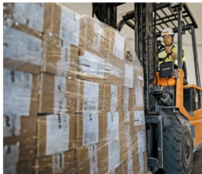
Die mit RFID-Readern ausgestatteten Gabelstapler erlauben die zuverlässige und schnelle Identifikation von Paletten und Behältern
