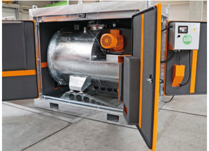
Im Kessel wird das Wasser aus dem Erdreich zwischengespeichert und von dort in ein Gewässer oder die Kanalisation gepumpt
