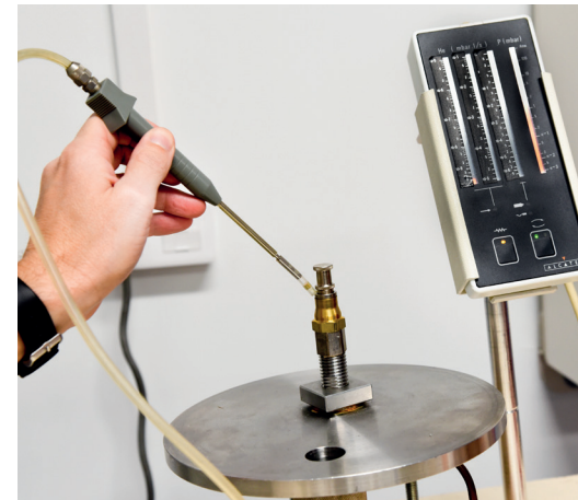
Helium-Massenspektrometer für Leckageratenmessungen
