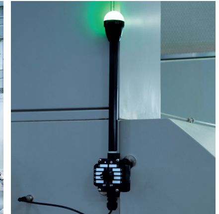
Le suivi de production peut être visualisé d'un seul coup d'œil et ajusté au moyen d'un commutateur rotatif manuel.
