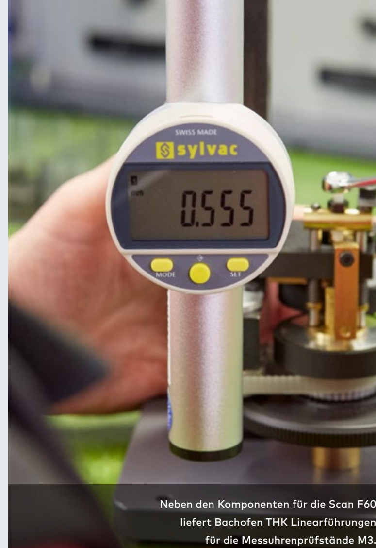
Die THK Linearführungen werden von Frau Neukomm, Team Leader Bancs de mesure bei Sylvac, in der Prüfstandsäule ausgerichtet. Sie ermöglichen Bewegungen unter höchsten Präzisionsanforderungen.
