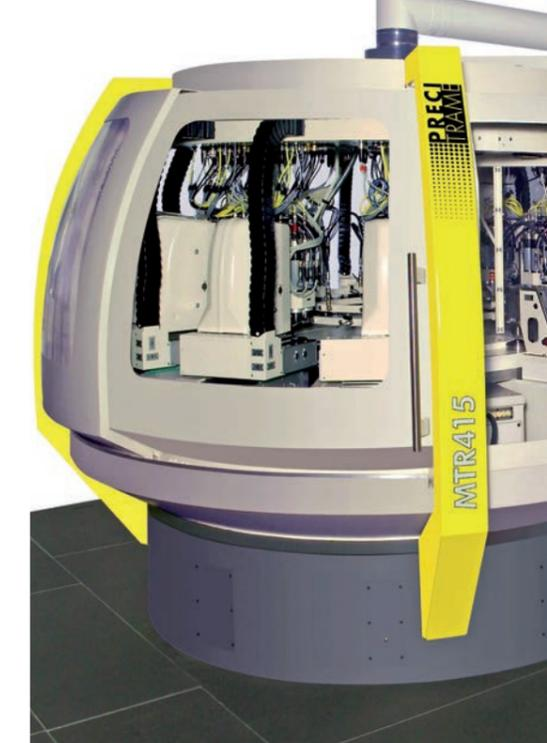
CNC-Rundtakt-Transfermaschine von Precitrame
