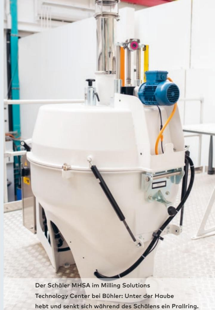
Der Schäl器 MSHA im Milling Solutions Technology Center bei Bühler: Unter der Haube hebt und senkt sich während des Schärens ein Prallring.
