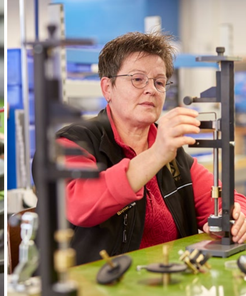
Les guidages linéaires THK sont positionnés dans la colonne de mesure par Mme Neukomm, chef d'équipe Bancs de mesure chez Sylvac. Ils permettent la réalisation de mouvements extrêmement précis.
