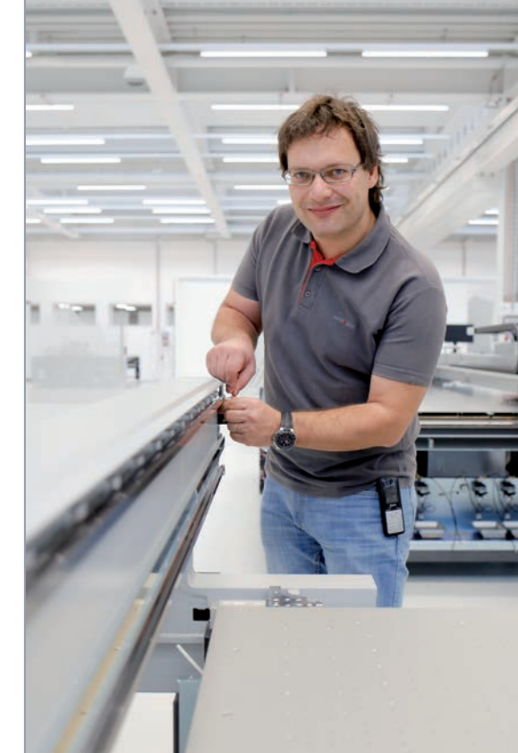
L'ingénieur de développement Norbert Bösch en train de monter les guidages THK de Bachofen sur la barre transversale
