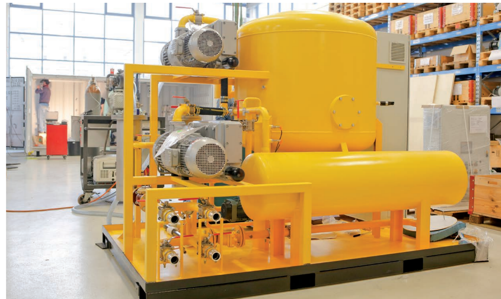
Installation de traitement des huiles VOP qui peut être télécommandée et entretenue par eWONFlexy quelle que soit la distance
