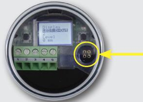
Anschlussstecker für MPI-200-F Adapter als Zwischenstecker zwischen ITM-51 Elektronik und MPI-200 Anschluss 3 (siehe nächstes Bild)
