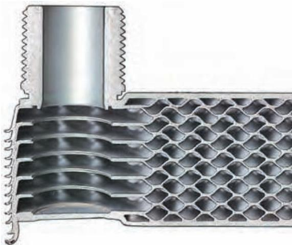
Das Ergebnis ähnelt eher Schweißverbindungen als Lötverbindungen. AlfaFusion ist eine neue, revolutionäre Technologie von Alfa Laval zum Fügen von Edelstahlkomponenten. Die beiden Edelstahlkomponenten schmelzen an den Kontaktstellen zwischen den gewellten Platten auf, so dass eine Fusionszone entsteht.
