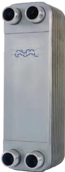
Die AlfaNova Geräte bestehen aus mehreren gewellten Edelstahlplatten, einer Rahmenplatte, einer Druckplatte und Anschlüssen – alle aus rostfreiem Edelstahl der Sorte 316.
