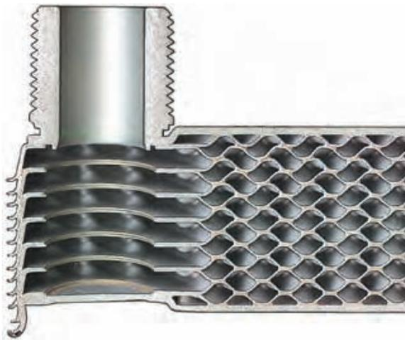
Dabei werden Edelstahlplatten durch Verlöten mit Kupferlot in einem Ofen miteinander verbunden. An den Kontaktstellen zwischen den gewellten Platten wird eine dünne Kupferschicht bei hoher Temperatur geschmolzen.
