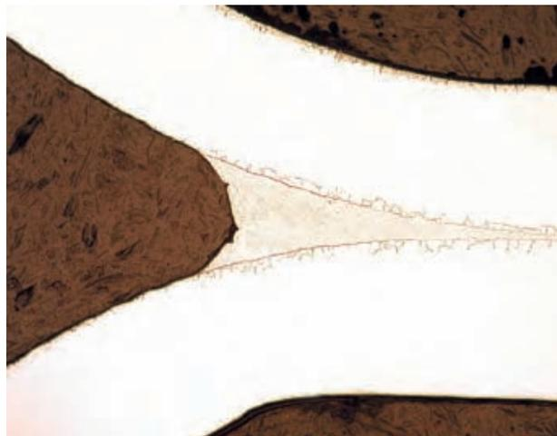
Bei Druckeinwirkung kann es zu beträchtlichen Werkstoffverformungen kommen, bevor sich ein Spalt bildet. Der Spannungsaufbau im Werkstoff führt zu einer Richtungsänderung, so dass die mechanische Belastung verringert wird.
