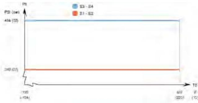
**CB400 - UL-Zulassung, Druck-/Temperaturdiagramm\***
